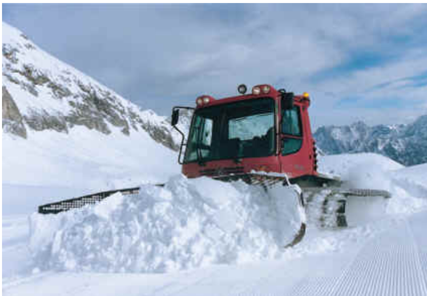
© Pisten Bully 200 mit einem 6-Zylinder-Dieselmotor von Mercedes-Benz und 205 kW (278 PS) Leistung.
